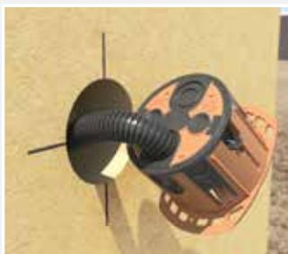
Placez le cadre de montage, puis insérez le câble ou le tuyau à travers la membrane hermétique dans la boîte.
