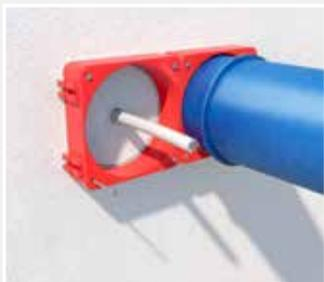
Faites deux ouvertures d'installation d'au moins 55 mm de profondeur et d'un diamètre de 68 mm à l'aide d'une fraise (n° art. 1088-07) et de deux aides au centrage (n° art. 1090-68).
